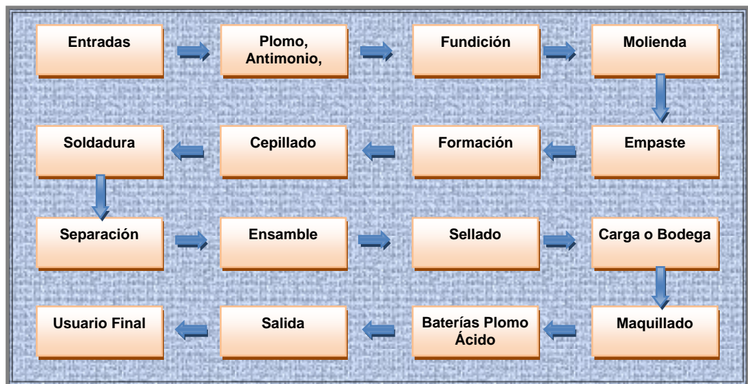
Figura 2. Flujograma del proceso de elaboración de baterías plomo ácido.
