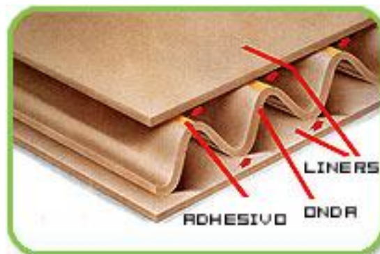
Figura 10. Partes que conforman el cartón corrugado
