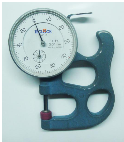
Figura 37: Calibrador de Gramaje
