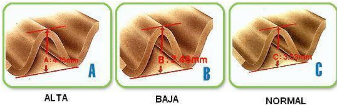
Figura 12. Variación del cartón corrugado según la altura de la onda
