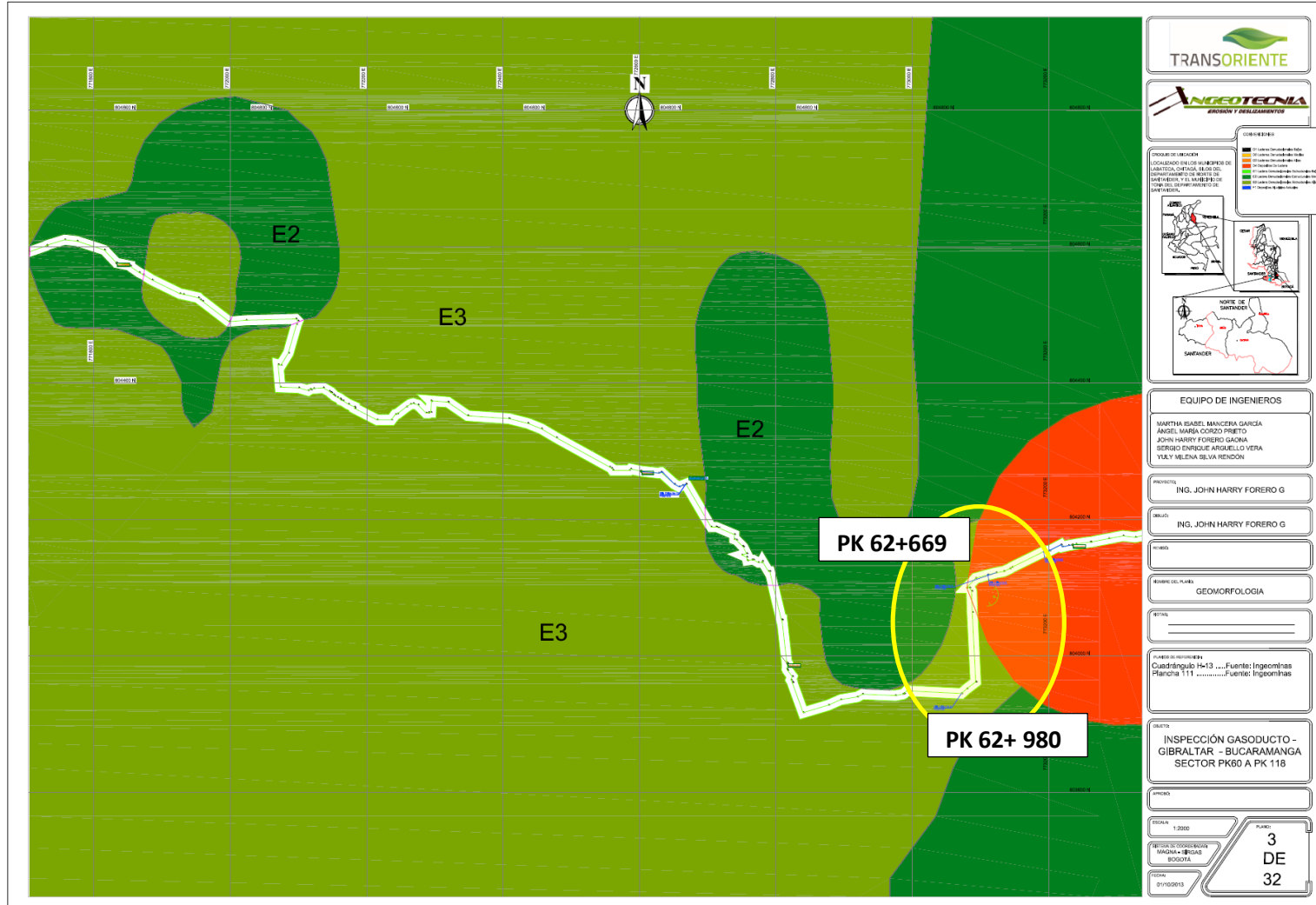
Figura 32. Plancha 3 de 32. Geomorfología. Ubicación de los Sitios críticos PK 62+669 y PK 62+980.
