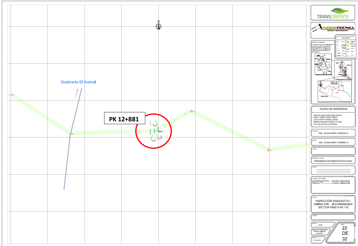
Figura 25. Plancha 22 de 32. Fenómenos de remoción en masa. Ubicación sitio crítico PK12+881.
