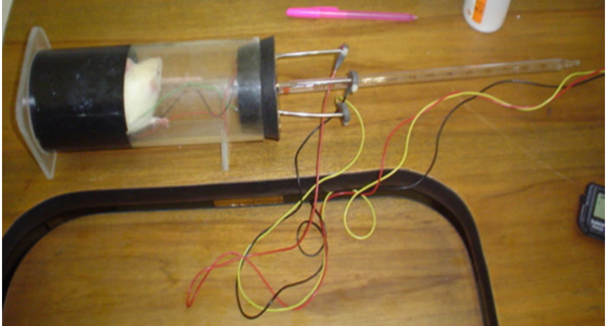
Figura 5. Fotografía del montaje de la cámara hermética para registrar el consumo de oxígeno.
