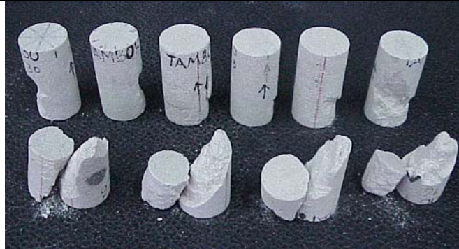
Fig. 58 Especímenes después de la prueba de Compresión Inconfinada
