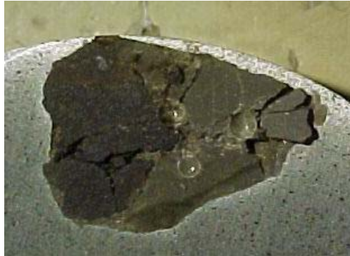
Fig. 16 Muestra de Shale destruida por el indentador de 1/16” En la prueba de Dureza Rockwell 15T con 15 Kg. de carga
