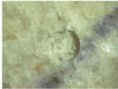
Fig. 62 Huella hecha por el indentador en la roca. Diámetro 1mm.
