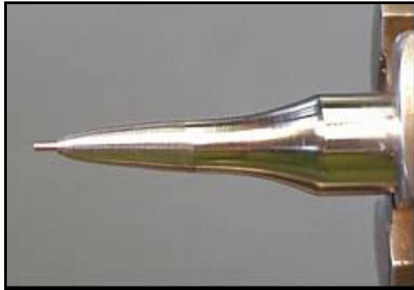
Fig. 37 Indentador. Dimensiones en la punta. 1mm de diámetro y 3mm de longitud
