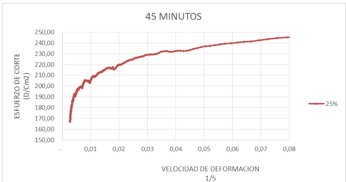
Figura 9. Esfuerzo cortante vs velocidad de deformación – pasta alimenticia tiempo de reposo de 45 minutos y humedad de 25% p/p
