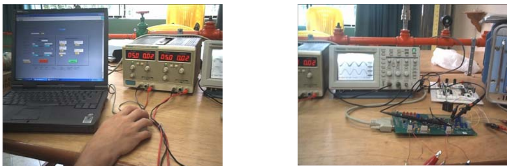
Figura 28. Pruebas de la tarjeta de evaluación para el CI ADE7756 en los laboratorios de la UIS
