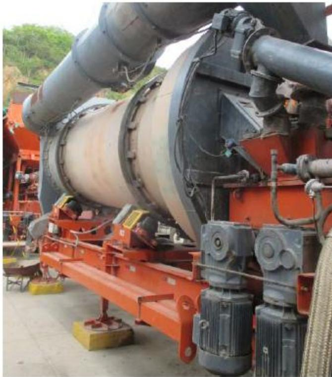
Figura 3. Tambor secador rotatorio y mezclador de la planta 2.
