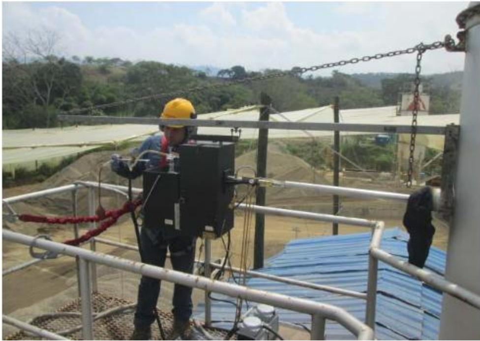
Figura 5. Toma de CO<sub>2</sub> y O<sub>2</sub>
