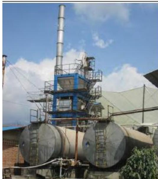
Figura 2 Tanques de calentamiento del asfalto, mezclador y chimenea de la planta 1.
