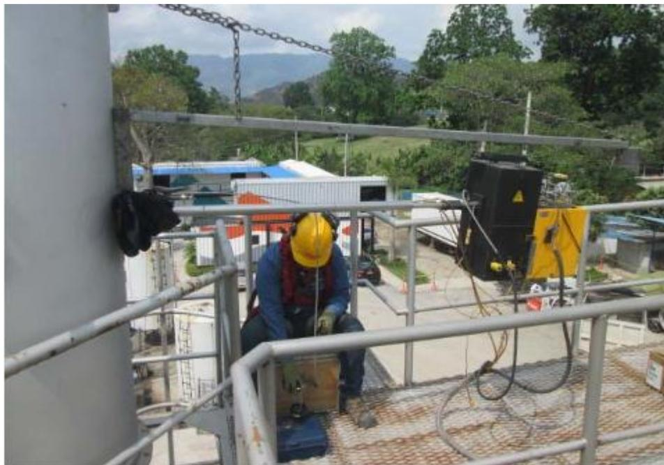
Figura 3. Tren de Muestreo del Bióxido de Azufre
