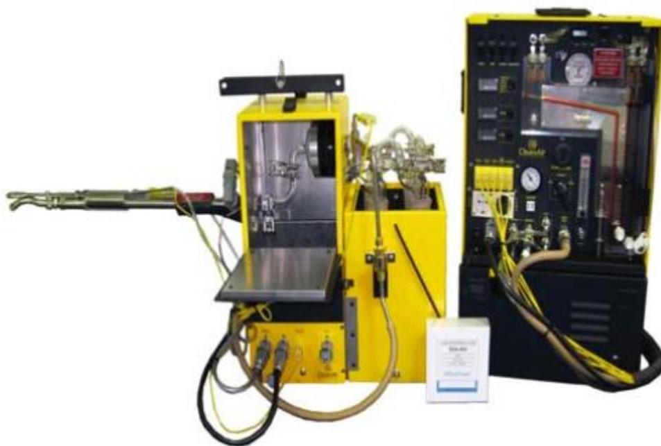
Figura 2. Tren de muestreo de material particulado
