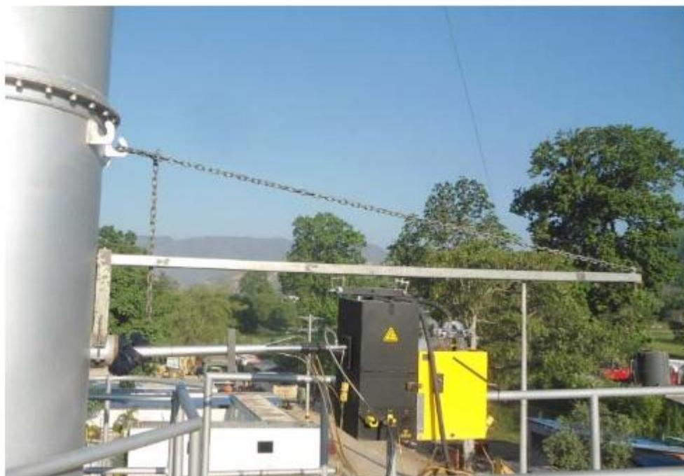
Figura 4. Tren de muestreo de los óxidos de Nitrógeno
