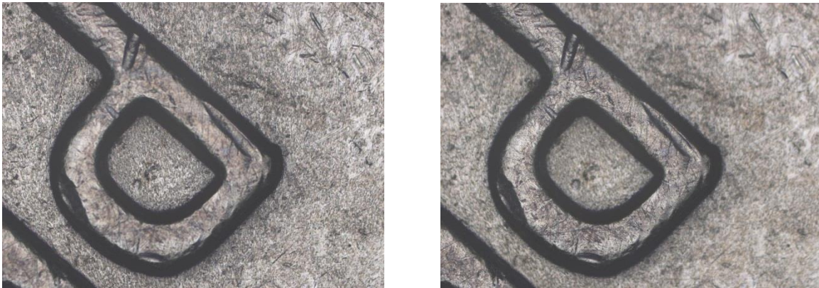
Figura 5: Imágenes microscópicas a una moneda con un objetivo 5X.
