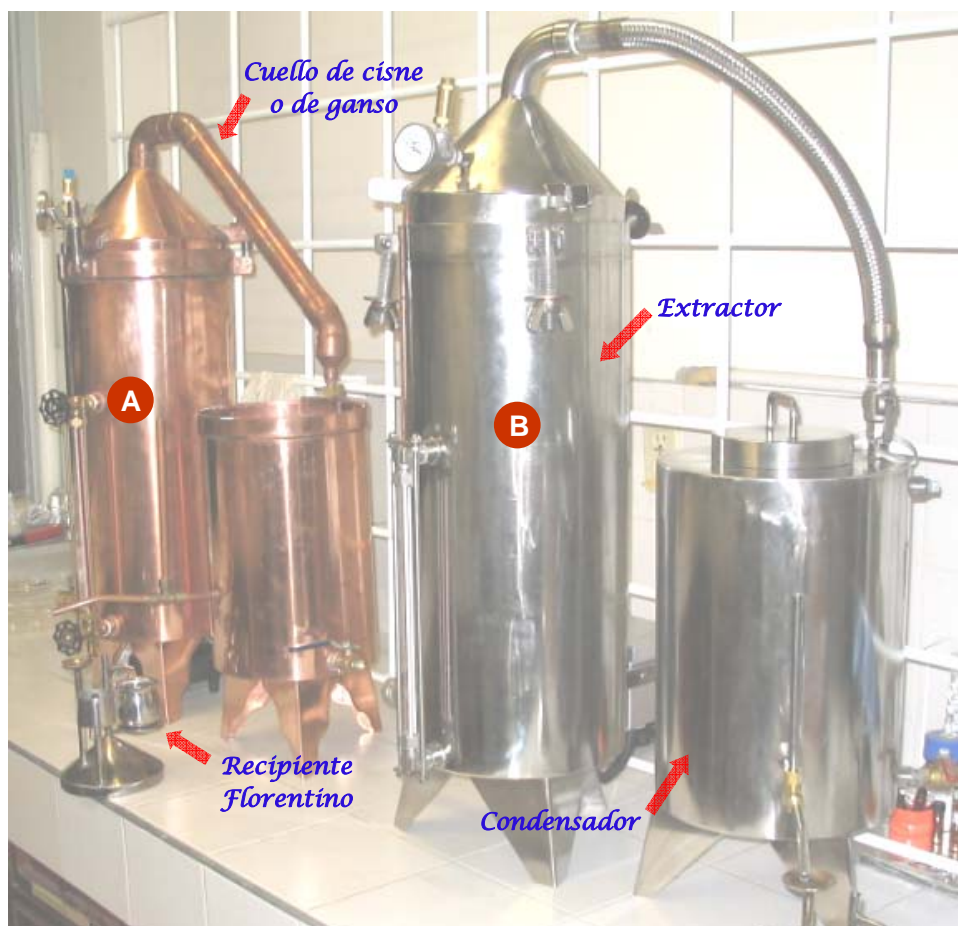
Figura 12. Destiladores semi-industriales. A. Destilador de cobre; B. Destilador de acero inoxidable.
