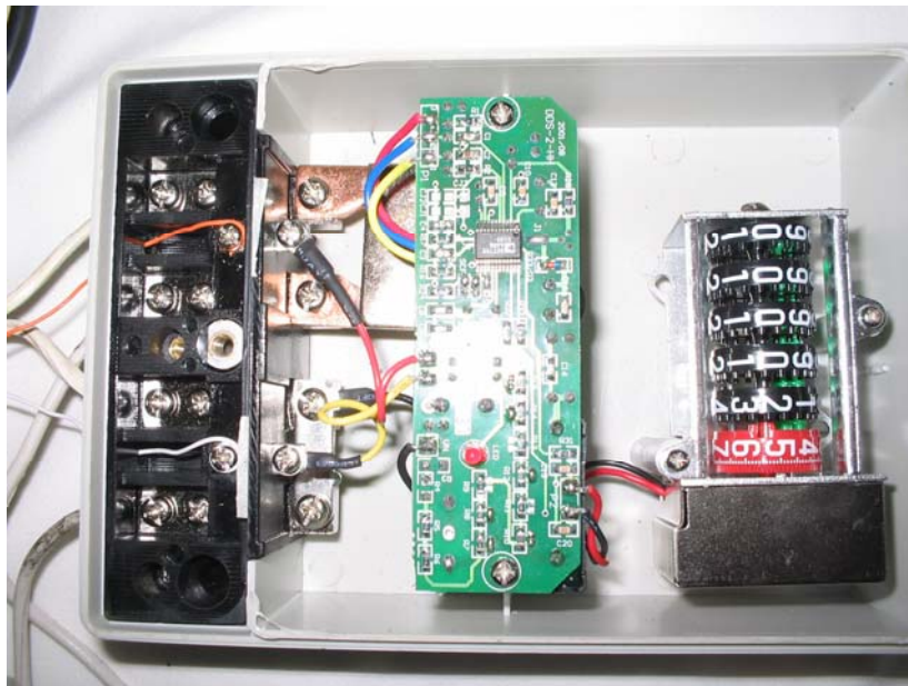
Figura 26 El interior del medidor electrónico.
