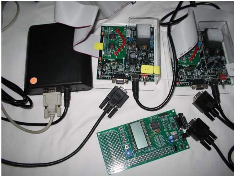
Figura 28 Opción de conexión de un “host” externo a un nodo esclavo
