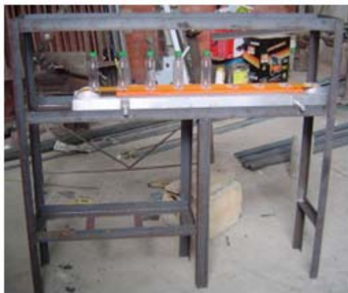
Figura 41. Banda montada en la estructura general
