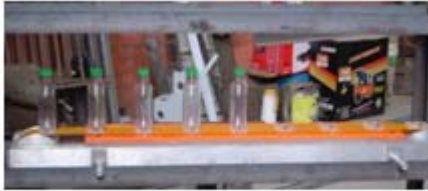
Figura 35. Montaje de la banda en estructura
