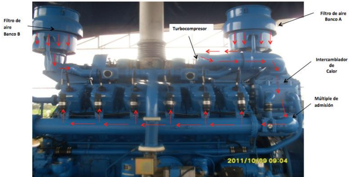
Figura No 11. Sistema de admisión y escape
