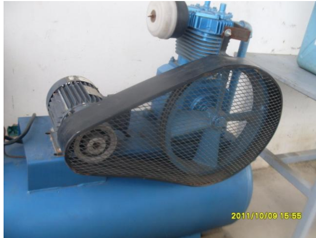
Figura No 8. Compresor de Aire
