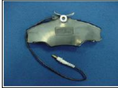
Figura 24. Pastillas con avisador luminosos de desgaste
