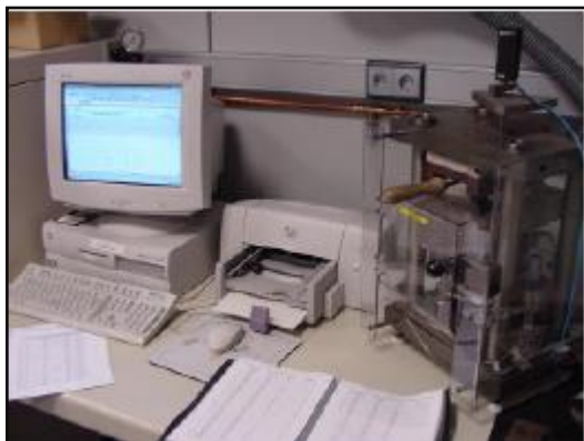
Figura 29. Máquina para ensayos de compresibilidad
