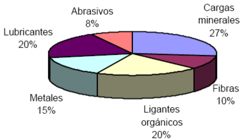
Figura 17. Composición de materiales de fricción.
