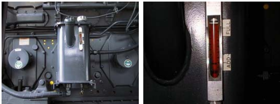
Figura 25. Nivel aceite hidráulico de actuadores
