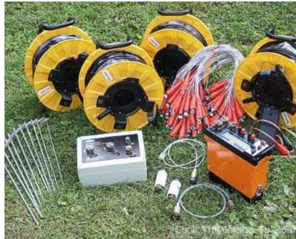
Figura 1. Equipo Geoeléctrico usado. Terrameter SAS – 1000
