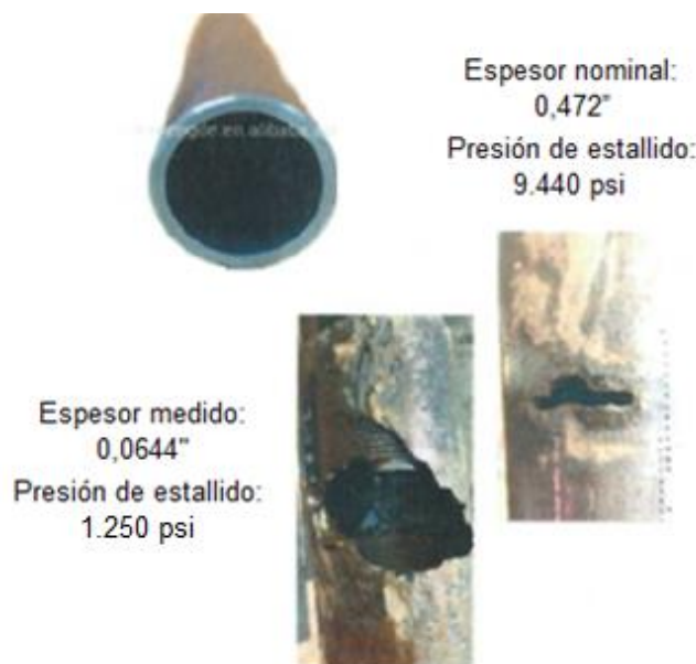
Figura 5. Presión de estallido del revestimiento de 9 5/8".
