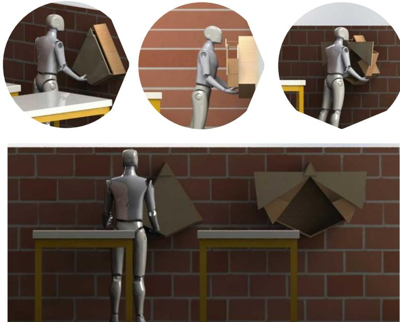
*Alternativa 2.* Su mecanismo se basa en dos resortes ubicados en la parte posterior de la estructura y conectados, a su vez, a las repisas por medio de cuerda, las cuales se accionan (girando cada una en un eje) por medio del peso del morral cuando es ubicado en su respectivo soporte. Lo anterior, permite que el sistema sea accionado en un solo paso, es decir, que puede desplegarse para ser usado, y cuando no se encuentre en uso reduzca su volumen (Figura 26).
