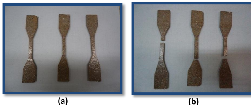
Figura 8. Probetas para el ensayo de tensión. (a) Probetas antes del ensayo; (b) Probetas después del ensayo.
