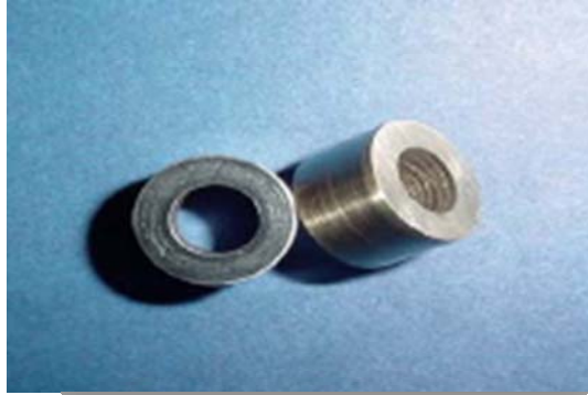
Fotografía 1. Probeta de acero API 5L X65.
