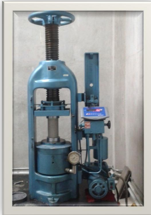
Figura 8.Registro de Resistencia a la Compresión. Fuente: [Autores]
