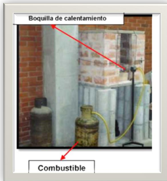
Figura 16. Horno utilizado para el Ensayo de Fuego. Fuente [Autores]
