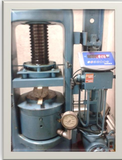
Figura 9. Registro de Resistencia a la Tracción Indirecta. Fuente: [Autores]
