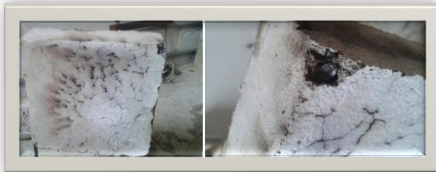
Figura 21. Probetas con Dosificación Después de ser Expuestas al Fuego. Fuente [Autores]
