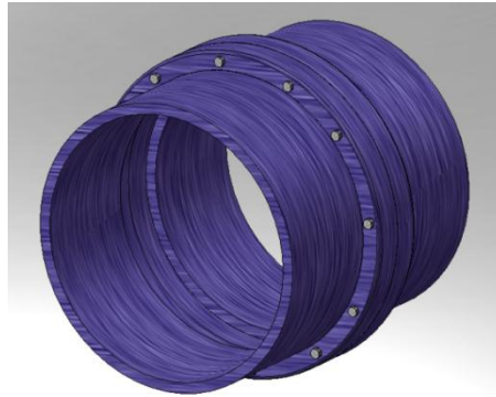
Figura 55. Juntas entre secciones del tobogán de entrada.
