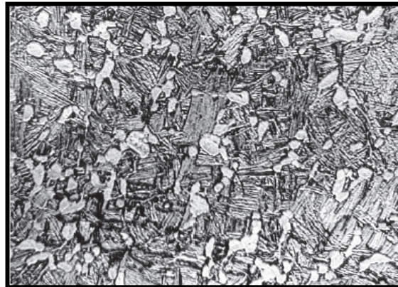
Figura 2. Microestructura duplex de Ti6Al4V, 100 \mu\text{m} . (59)
