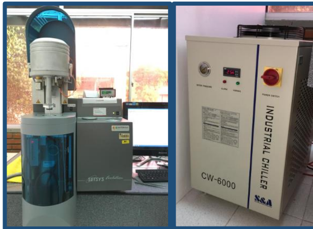
Figura 1. Equipo SETSYS Evolution SETARAM y unidad industrial CHILLER CW-6000
