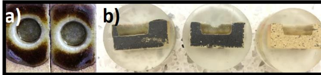
Figura 13. Ladrillos refractarios después de realizada la prueba de resistencia al ataque por escoria a) vista superior, b) sección transversal.
