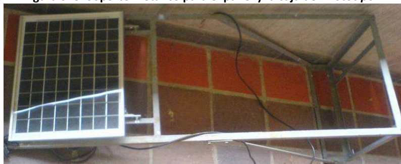
Figura 3. 8. Soporte metálico para el panel y la caja del Prototipo 1
