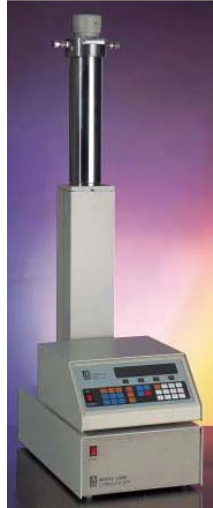
Figura 71. Bomba de desplazamiento positivo y sus datos.
