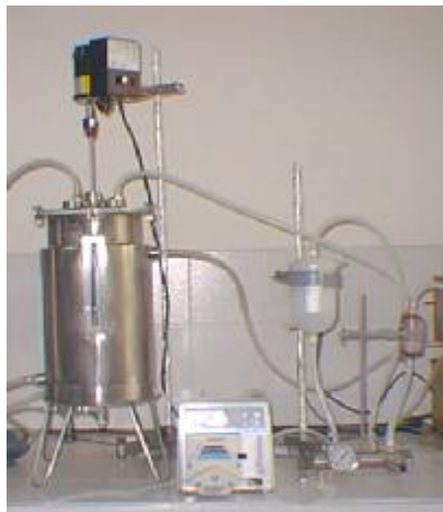
Figura 60. Bioreactor sacarificación en continuo con el prefiltro y el ultrafiltro
