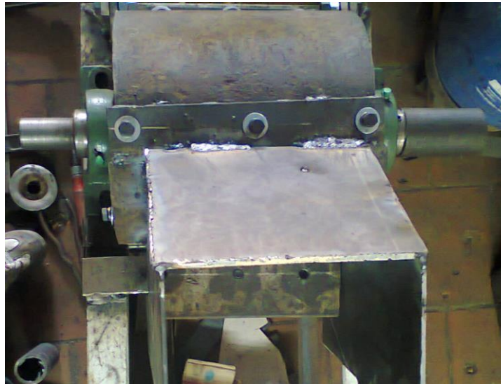
Figura 85. Base de la tolva asegurada a la tapa superior.
