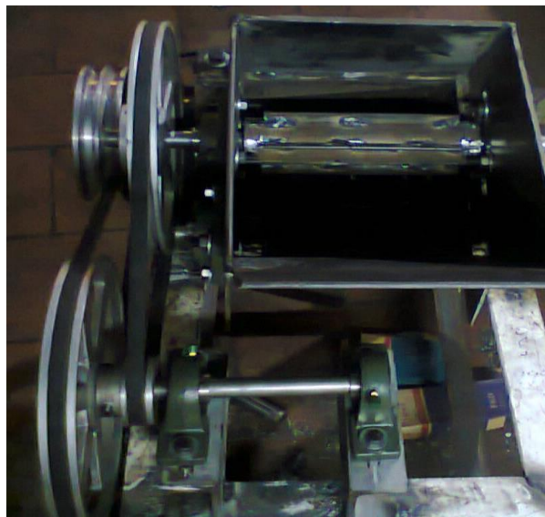
Figura 89. Montaje del rodillo impulsor.
