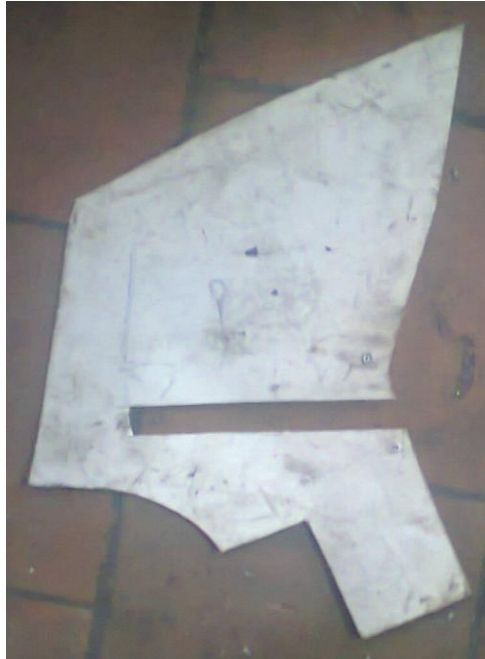
Figura 86. Molde lateral de la tolva en papel cartón.
