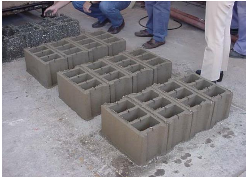
Figura 6. Ladrillos con RPET.
