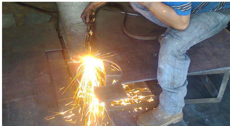
Figura 71. Corte de ruedas con oxicorte.
