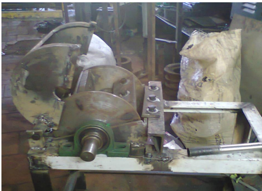
Figura 84. Tapa superior con sus apoyos.
