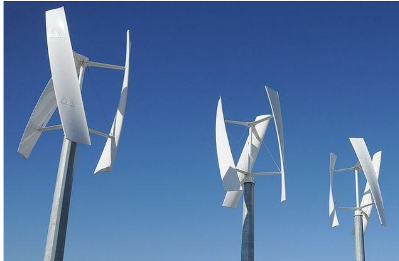
Figura 16. Aerogeneradores de Eje Vertical
