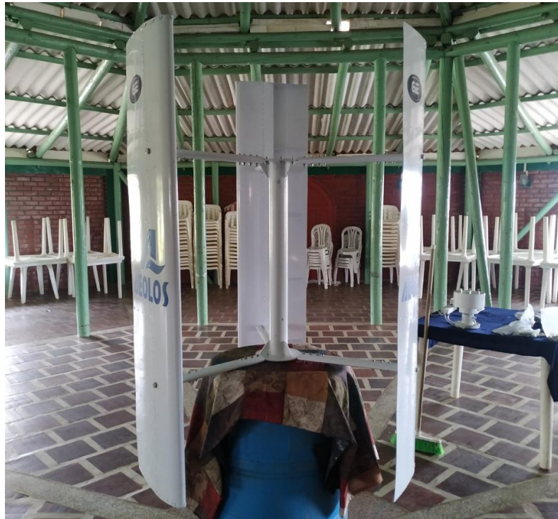
Figura 72. Ensamblaje del Aerogenerador Vertical Aeolos V-300W, segunda parte.
