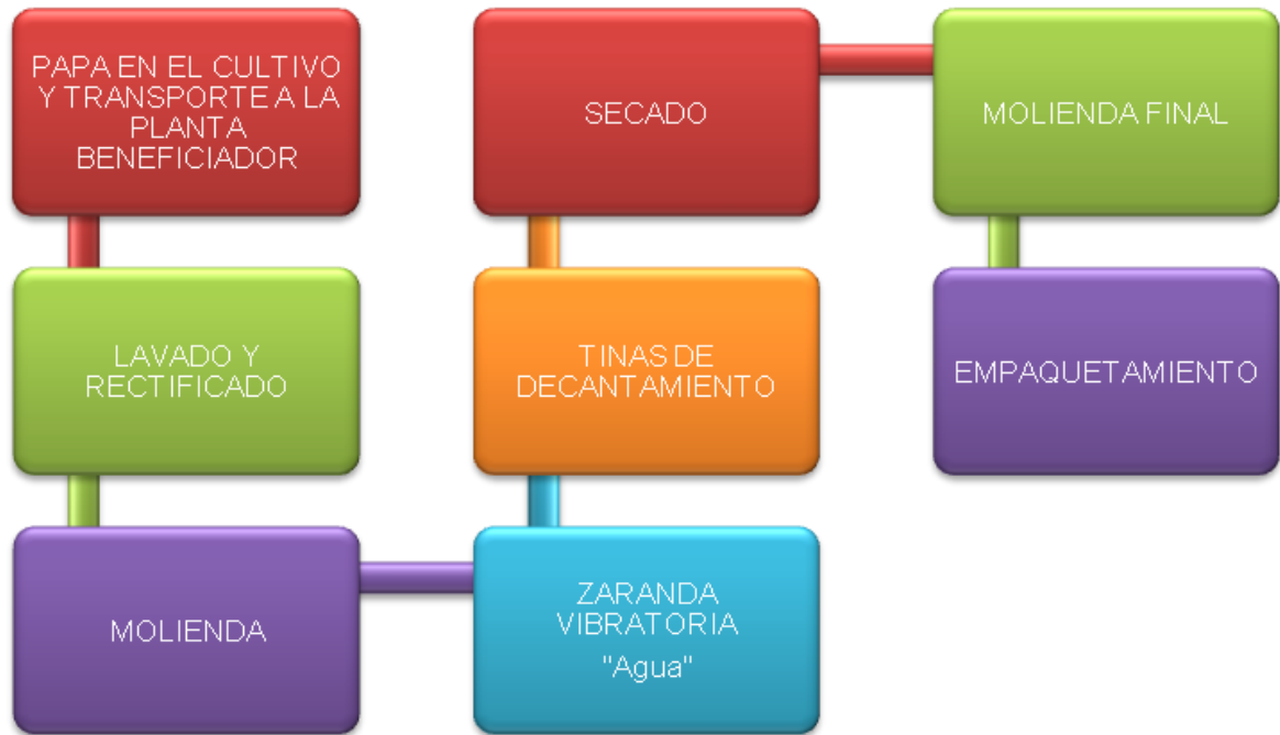
Figura 14. Diagrama del proceso general de extracción de almidón de papa.
