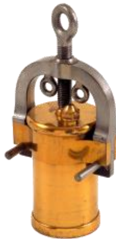
Figura 9. Marmita Papin. El Museo Nacional de Ciencia y Tecnología de España (MUNCYT).
