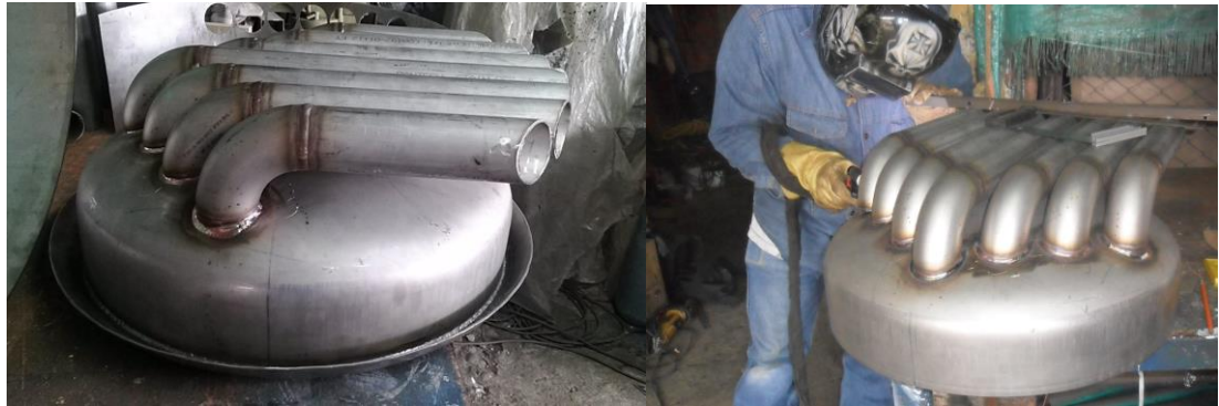
Figura 28. Proceso de fabricación del Intercambiador de calor
