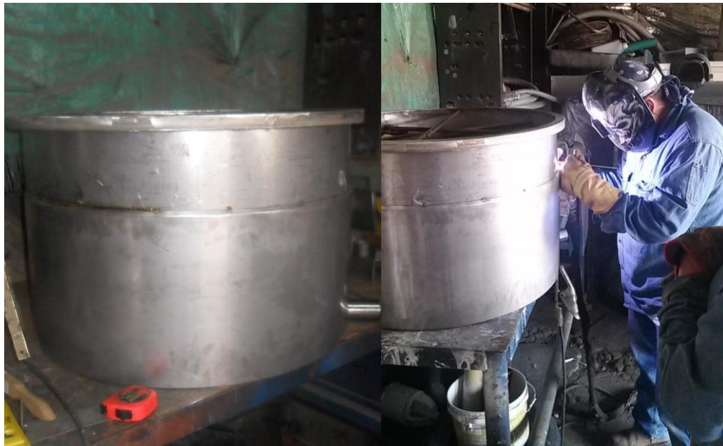
Figura 27. Proceso de fabricación de la chaqueta de vapor
