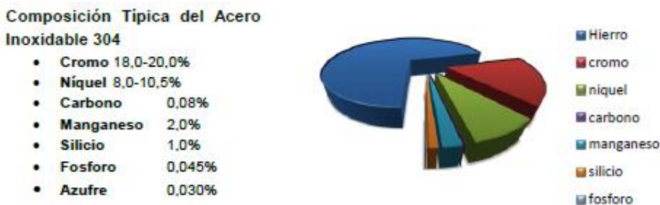
Figura 10. Composición típica del Acero Inoxidable 304, según ASTM A240
