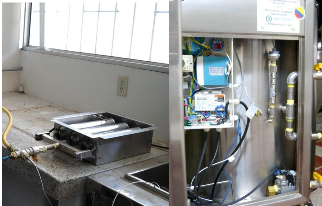
Figura 29. Ensamblaje instrumentación de la marmita
