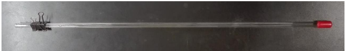
Figura B.2. Tubo de cuarzo utilizado como contenedor de la solución a irradiar.
