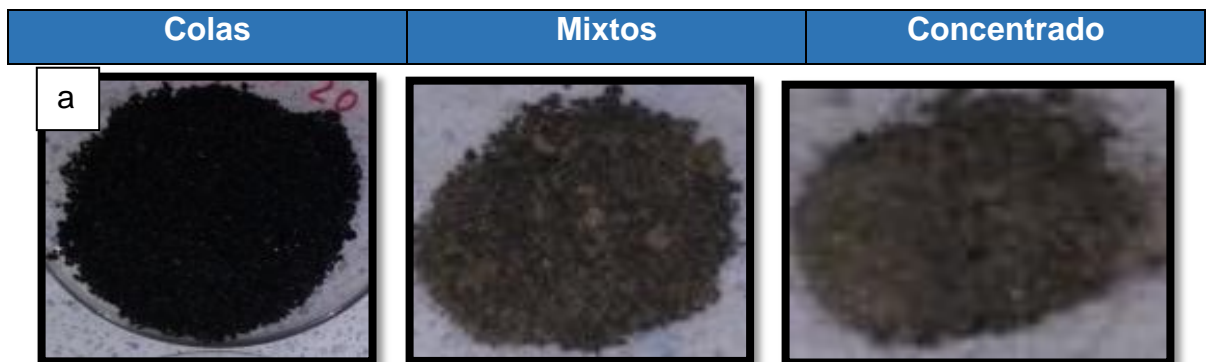
Figura 16. Productos de concentración en Mesa Wilfley a) 20°, b) 15°, c) 10°
