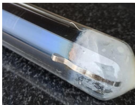
figura 34 Ilustración del fallo por perdida de vacío en el tubo.
