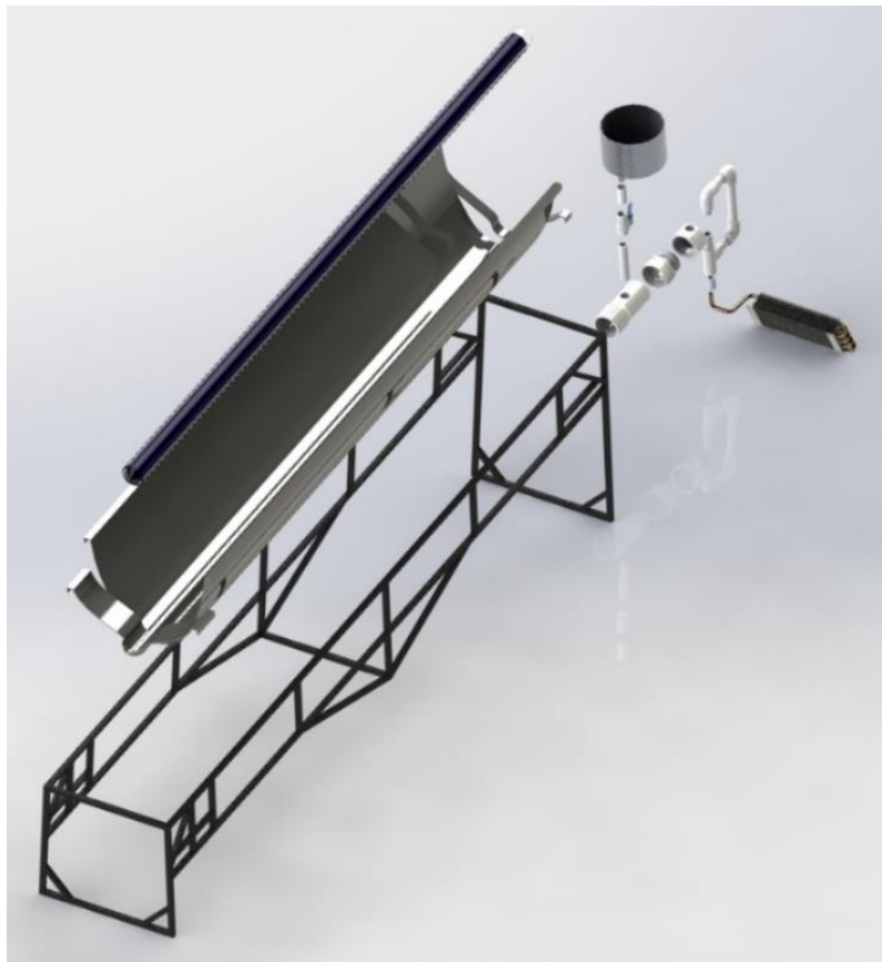
figura 21 Vista explosionada del sistema.
