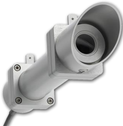
figura 9. Representación del pirheliómetro.
