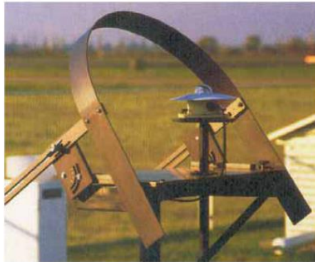
figura 11. Representación del piranómetro con sombra para medir radiación difusa.
