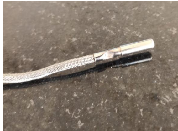
figura 31 Termocuplas tipo K sin lóbulo expuesto.
