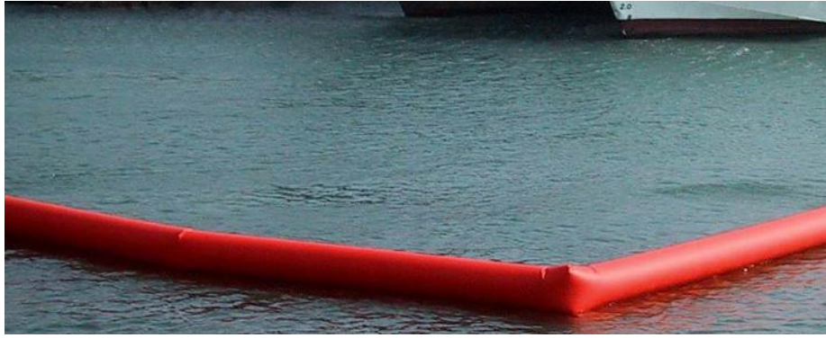
Figura 10. Barreras tipo cortina inflable a presión. Adaptado de Canadyne Technologies Inc. (2020). Containment booms . Recuperado de http://www.canatec.com/pressure-inflatable-booms . Canadá.
