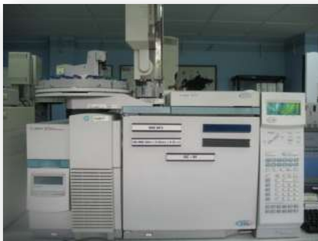
Figura 10. Cromatógrafo de gases Agilent GC 6890 Series GC System acoplado a un detector selectivo de masas ( Agilent MSD 5973 ).
