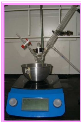
Figura 9. Montaje para la reacción de ataque con ácido sulfúrico.
