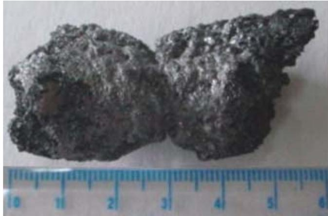
**Fotografía19.** Productos de coquización de briquetas, mezcla de carbón TipoII con seis por ciento de bentonita y doce por ciento de humedad.
