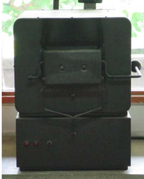
**2.2.1.8 Determinación de porcentaje de materia volátil en las muestras.** La determinación de porcentaje de materia volátil en carbones se realizó de acuerdo a la norma ASTM D 3175- 01.<sup>(11)</sup>
