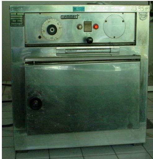
**2.2.1.6 Determinación de la humedad en las muestras.** La determinación de la humedad en carbones se realizó de acuerdo a la norma ASTM D3173-00.<sup>(9)</sup>
