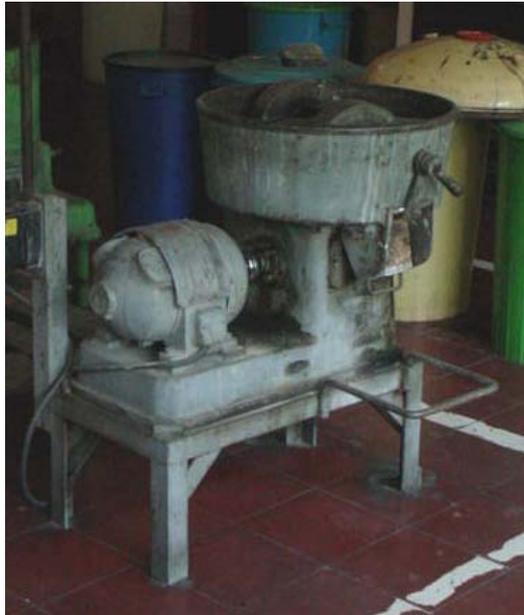
**Fotografía 6.** Briqueadora a nivel de laboratorio.
