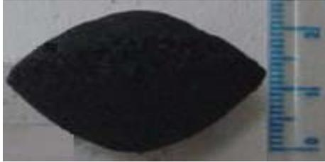
**Fotografía 11.** Briquetas de mezcla de carbón alto volátil con tres por ciento de bentonita y doce por ciento de humedad, en la cual se efectuó un tratamiento térmico durante 60 min. a una temperatura de 75°C.
