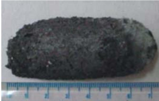
**Fotografía18.** Productos de coquización de briquetas, mezcla de carbón TipoIII con tres por ciento de bentonita y doce por ciento de humedad.
