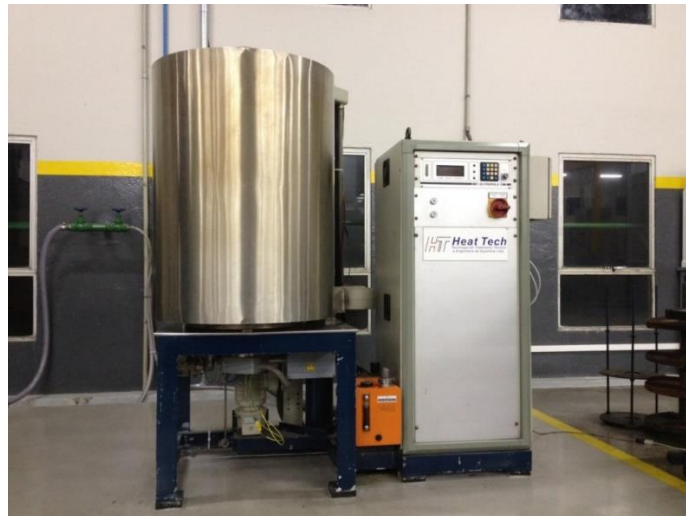
Figura 6 Reactor de Nitruración a plasma- Eltropuls. Empresa Heat Tech
