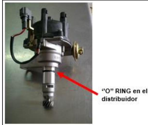
Figura 2. Ubicación del "O" RING en un distribuidor
