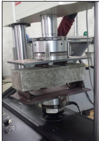
Figura 8. Montaje viguetas para ensayo de flexión.
