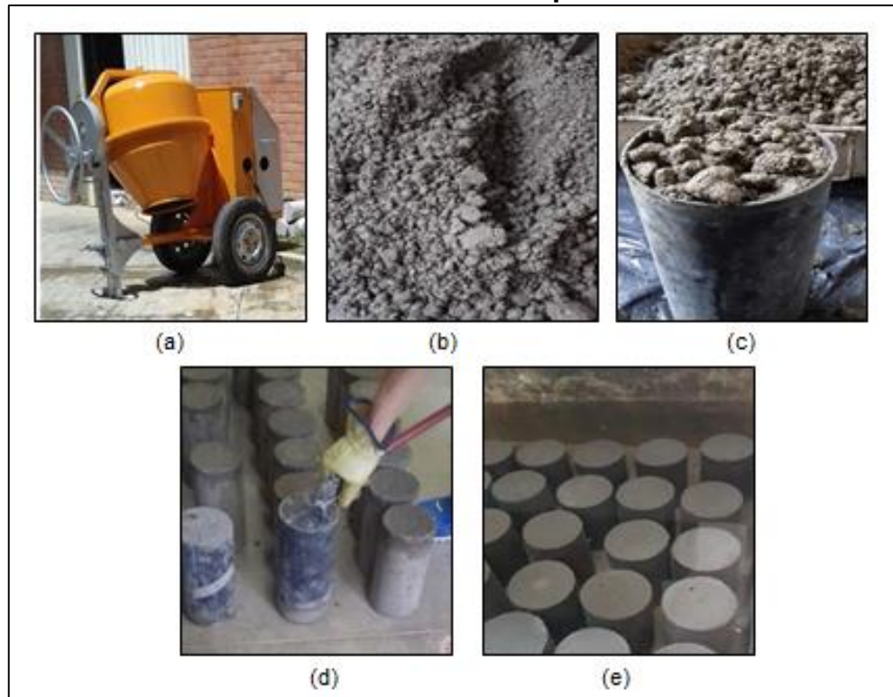
Figura 5. Procedimiento de fabricación de las probetas.
