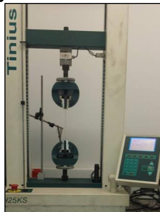
Figura 4. Montaje para ensayo de resistencia a la tracción de la fibra de fique.
