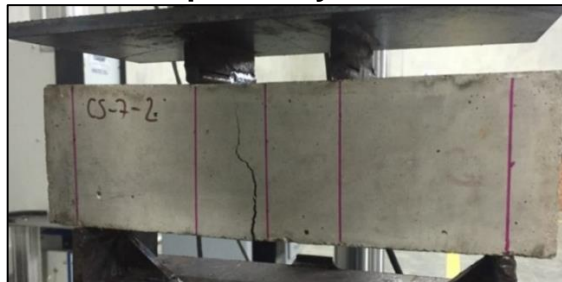
Figura 16. Probeta de concreto simple ensayada a flexión.
