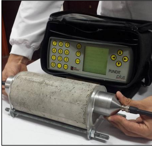
Figura 6. Ensayo de Velocidad de Pulso Ultrasónico.
