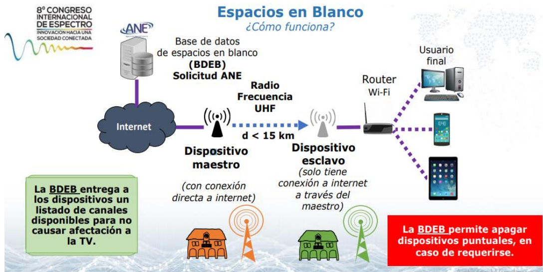
Figura 7. Infraestructura de una red TVWS.
