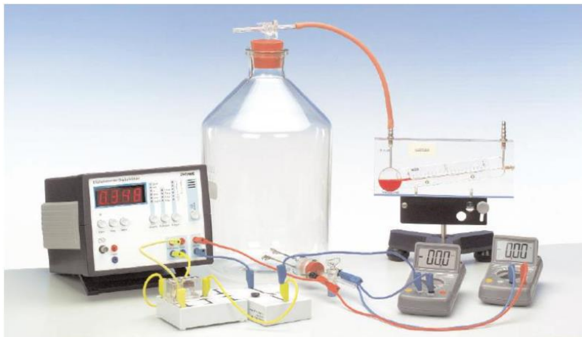
Figura 2: Montaje Experimental para determinar C_v . Tomado del manual de laboratorio de fisicoquímica II [3].
