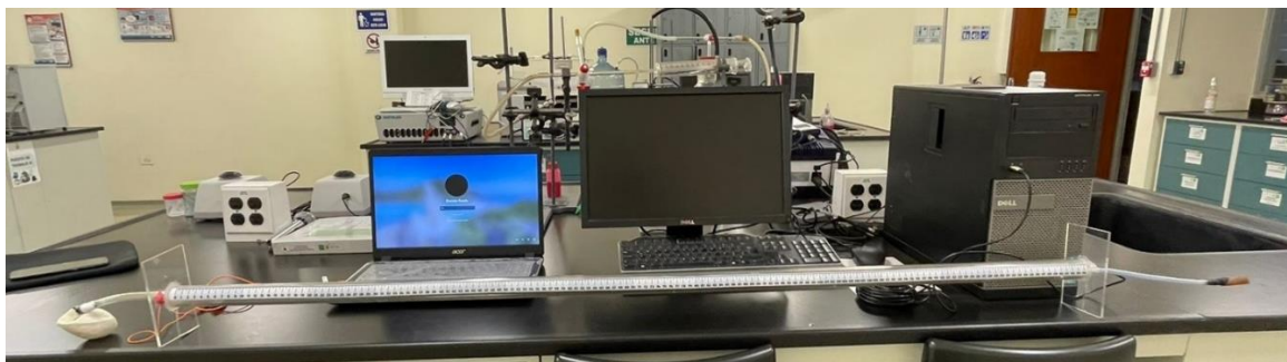
Figure 1. Experimental configuración para medir la velocidad del sonido en gas. (Fuente: Autor del proyecto)
