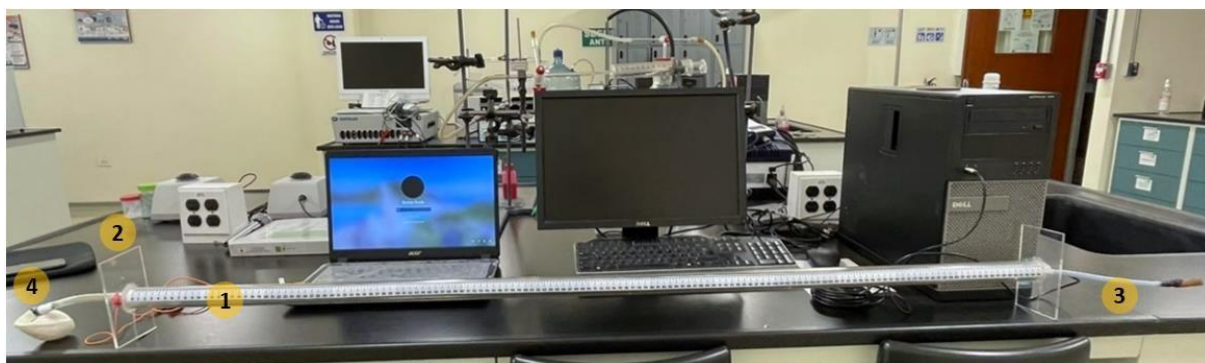
Figura 6. Montaje experimental tubo de Kundt. (1) Tubo acrílico de 1,42 \text{ m} \pm 0,02 \text{ m} , (2) Tapa izquierda, conexión de auricular y salida de gas, (3) Tapa derecha, conexión del micrófono y entrada de gas, (4) Bomba R12 blanca. (Fuente: Autor del proyecto).
