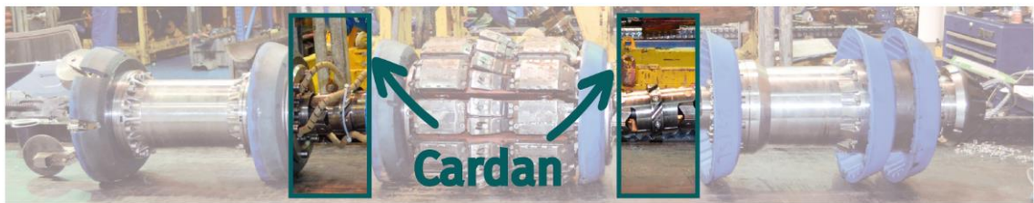
Ilustración 41 Ubicación de cardan en el PIG.
