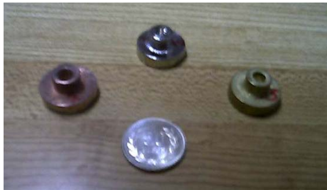
Figura 49. Probetas de Cobre, Níquel y Latón.
