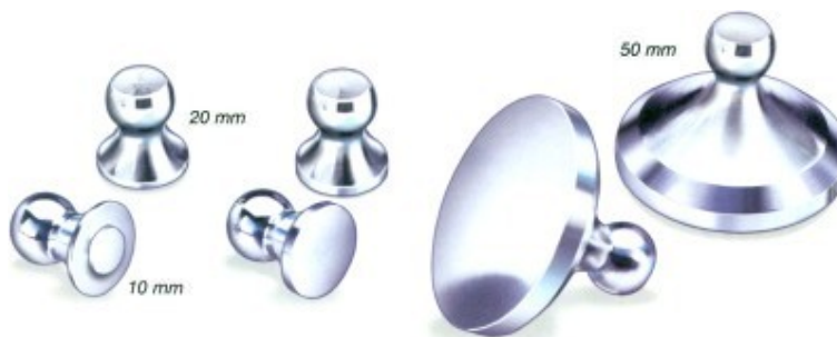
Figura 10. Dollies utilizados en los ensayos Pull-Off .
