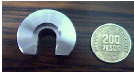
Figura 19. Accesorio para Fijación del conjunto dolly -probeta.
