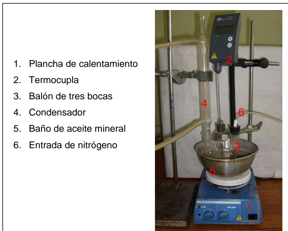
Figura 7. Montaje para la preactivación de la reacción
