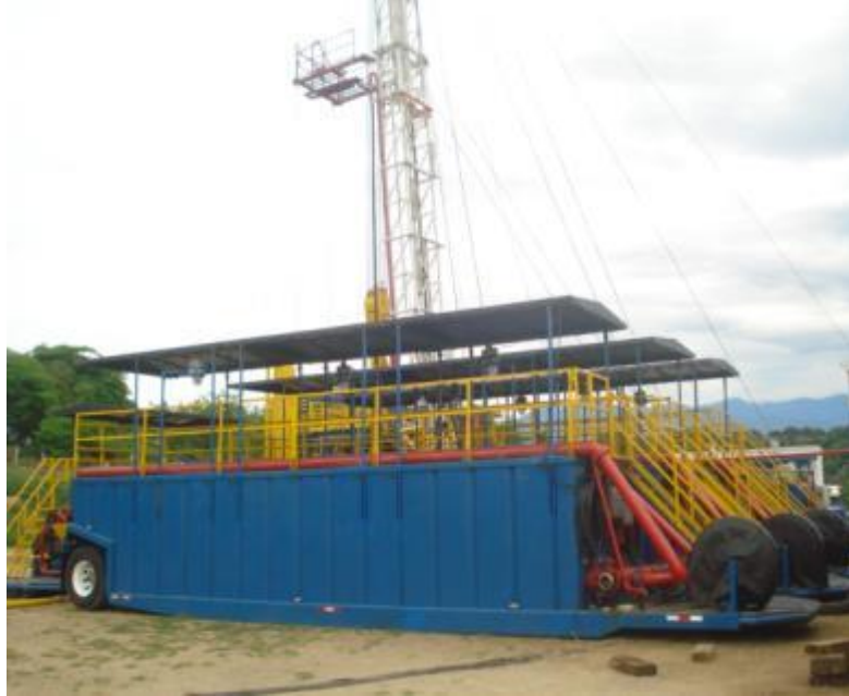
Figura 28: Tanques de lodos
