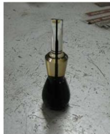
Figura 16. Picnómetro para medir la densidad del crudo. Fuente: autores.
