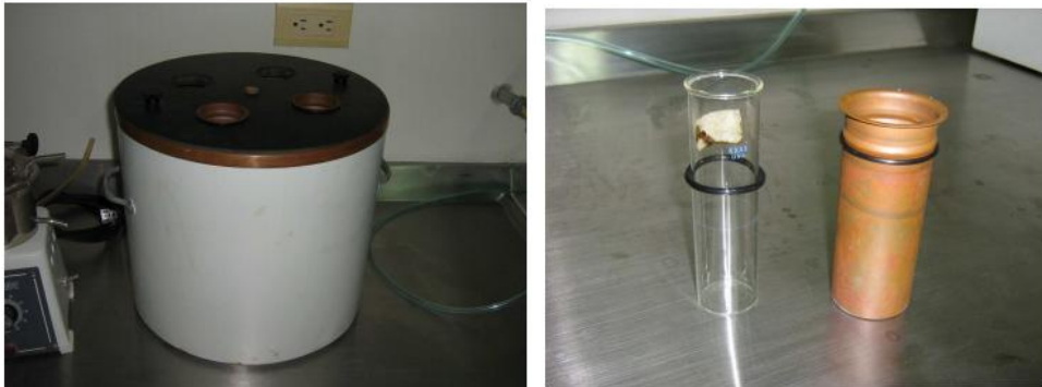
Figura 17. Equipo de laboratorio para determinar el punto de fluidez. Fuente: autores.
