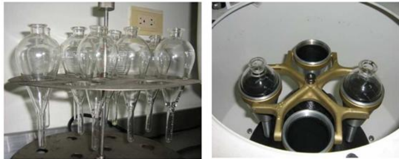
Figura 15. Centrifuga y recipientes para la medida de BSW. Fuente: Autores
