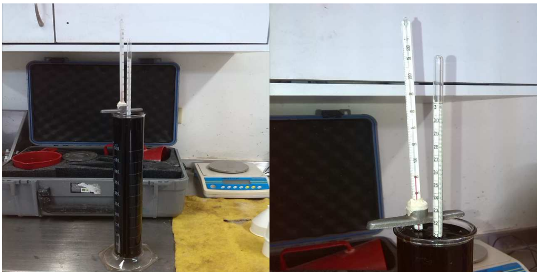
Figura 25 Medición de la Gravedad API con Hidrómetro
