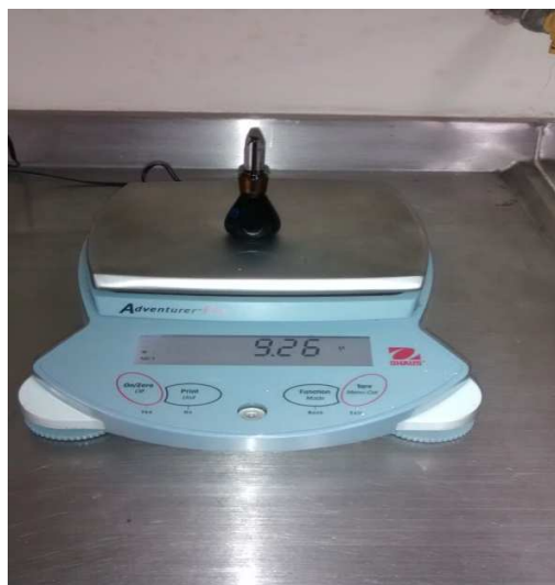
Figura 26 Pesaje del picnómetro
