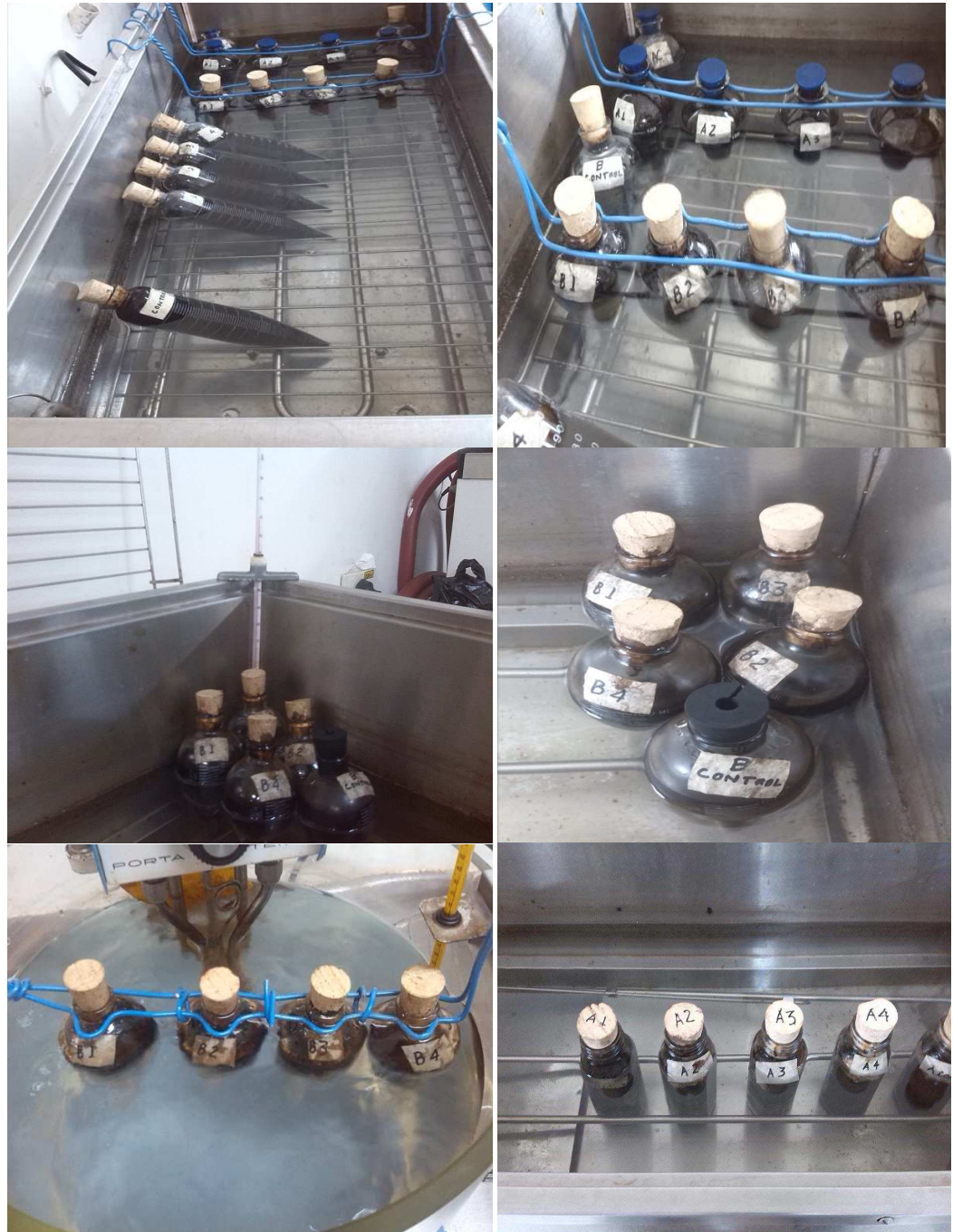
Figura 52 Montaje de frascos apiñados entre sí, apiñados contra las paredes del baño y completamente separados
