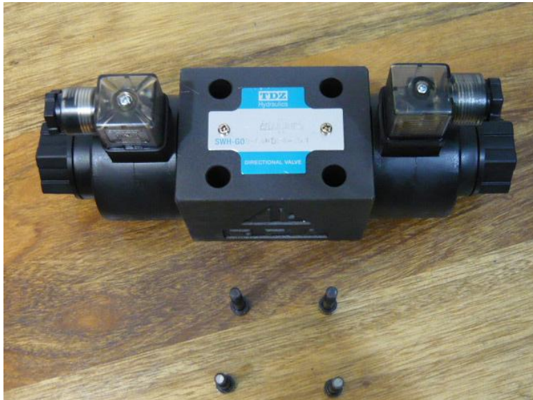
Figura 81: Válvula direccional CETOP 5 TDZ punto flotante 4 vías 3 posiciones.
