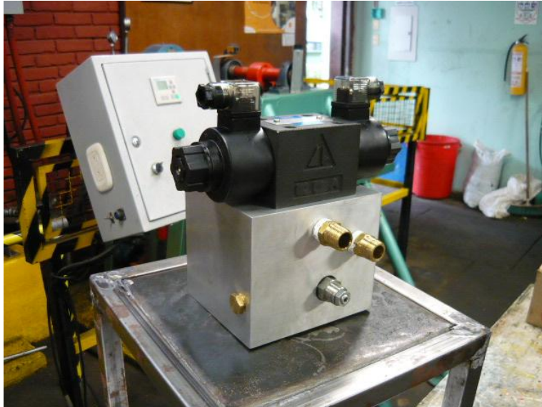
Figura 87. Montaje del Manifold.
