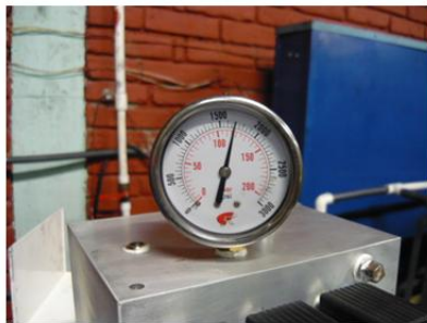
Figura 93. Prueba a 1800 PSI.
